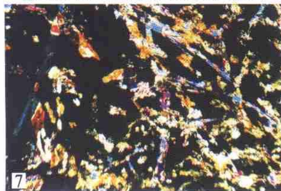
7 锰镁闪石夕卡岩(黑色矿物为黄铁矿), ×32, 正交偏光, 辽宁八家子矿区红旗矿段
